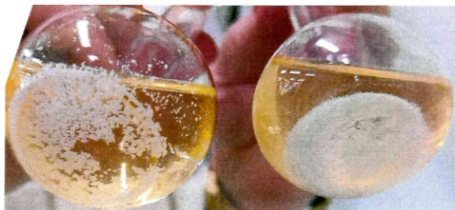
Рисунок № 3 – осадок при испытании АИ-95-К5 и АИ-100-К5
